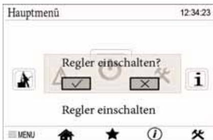
Nach erfolgter Bestätigung wird der Kessel gestartet.
