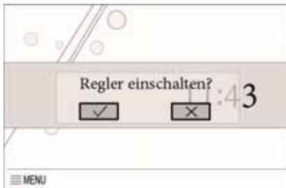
Nach erfolgter Bestätigung wird der Kessel gestartet.
