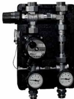
Der Regumat besteht aus einem 3-Wege-Mischerventil, einer Umlaufpumpe, einem Absperrventil, Thermometer und Wärmedämmung. Der Vorteil dieser Lösung liegt in der Kompaktheit, Einfachheit der Bedienung und im garantiertem Schutz des Wärmetauschers des Kessels.
