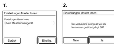
Wenn das Master-Innengerät geändert wird, kann ein weiteres Innengerät nicht zum Master-Innengerät gemacht werden, es sei denn die Einstellungen des aktuellen Master-Innengeräts wurden vorher abgebrochen. (Während das Innengerät in Betrieb ist, kann kein „Reset“ durchgeführt werden.)
