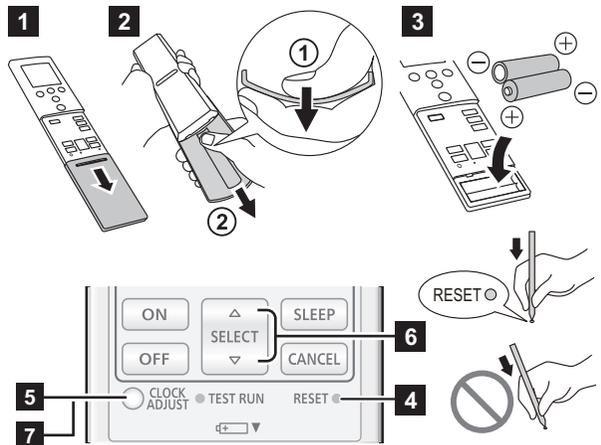
**1** Ziehen Sie die Abdeckung in Pfeilrichtung und öffnen Sie sie bis sie fest sitzt.
