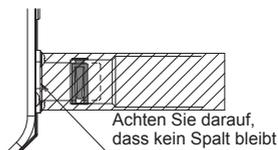
Wickeln Sie die angebrachte Wärmeisolierung um das Schlauchband und stellen Sie sicher, dass die Ausrichtung oben liegt
