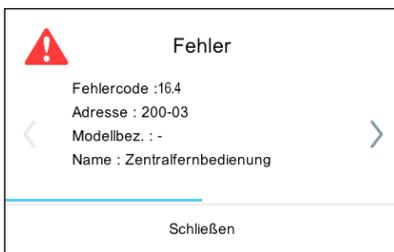
Wenn die [Fehler]-Taste angetippt wird, wird die Fehlerinformation (Fehler-Benachrichtigung oder Kühlmittleckage) auf dem Bildschirm angezeigt. Wenden Sie sich bei Bedarf an die Kundendienst-Abteilung.
