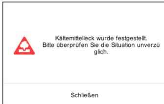
Wenn eine Kühlmittelleckage erkannt wird, wird die folgende Meldung vorne auf dem Bildschirm angezeigt. Bestätigen Sie den Fehlerort.
