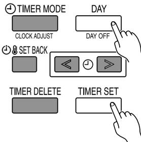
Drücken Sie die Tag-Taste "DAY" ("DAY OFF") und die Timer-Einstelltaste "TIMER SET" gleichzeitig länger als 2 Sekunden, um die Kindersicherung einzuschalten und alle Tasten auf der Fernbedienung zu sperren. Drücken Sie die Tasten nochmals 2 Sekunden lang oder länger, um die Kindersicherung auszuschalten.
