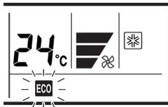
Drücken Sie die Energiespar-/Thermosensortaste "ECONOMY / THERMO SENSOR" zum Starten oder Stoppen des ENERGIESPARBETRIEBS.
