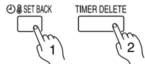
Drücken Sie die Taste "SET BACK" und anschließend die Taste "TIMER DELETE", solange die ZURÜCKSETZ-Bestätigungsanzeige angezeigt wird. Selbst wenn die Taste "SET BACK" erneut gedrückt wird, wird der ZURÜCKSETZ-Timer beendet.
