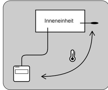
Drücken Sie die Taste "ECONOMY / THERMO SENSOR" länger als 2 Sekunden, um auszuwählen, ob die Raumtemperatur am Innengerät (Fern-Sensor) oder an der Fernbedienung erkannt werden soll.
