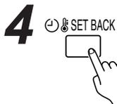
Die Taste "⌚ SET BACK" drücken, um zwischen 12- und 24-Stunden-Format zu wechseln.
