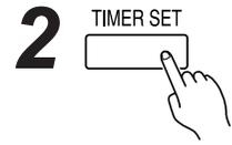
Drücken Sie die Taste "TIMER SET" für mindestens zwei Sekunden. Es wird in den Einstellmodus gewechselt, wenn die Taste innerhalb von 5 Sekunden gedrückt wird, nachdem die LCD-Anzeige von Schritt 1 angezeigt wird.
