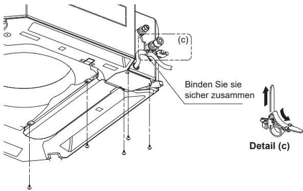
(4) Installieren Sie die Schaltkastenabdeckung.
