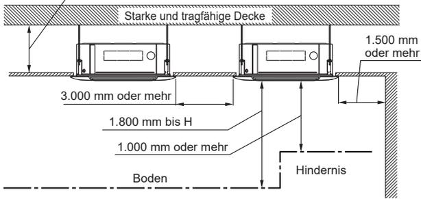
**H: maximale Höhe vom Fußboden zur Decke**
