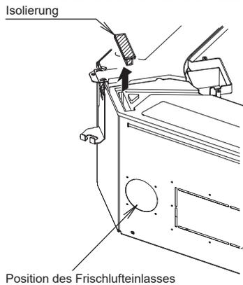
\* Entfernen Sie bitte die Isolation an der Drainagepfanne, wenn die Frischluft einströmt.
