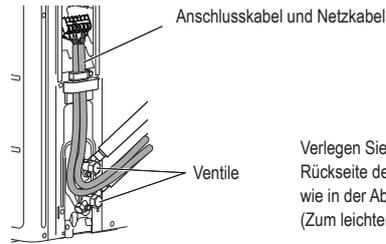
Verlegen Sie das Anschlusskabel und Netzkabel auf der Rückseite des Außengeräts zwischen den 2 Ventilen, wie in der Abbildung gezeigt.
