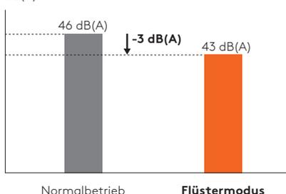
Die Luftzirkulation der Inneneinheit wird stark reduziert, so dass sie kaum mehr hörbar ist. Gleichzeitig fährt die Lüfterleistung an der Außeneinheit herunter, da durch die niedrigen Außentemperaturen in der Nacht nur ein geringer Teil der maximalen Leistung benötigt wird. So können auch Ihre Nachbarn ungestört schlafen.
