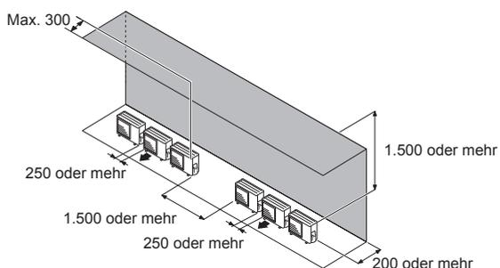
**4.3.3. Mehrreihige Außengeräte-Installation** (Einheit: mm)
