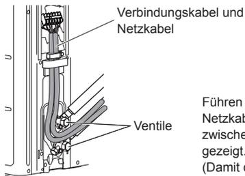
Führen Sie der Verbindungskabel und das Netzkabel auf die Rückseite des Außengeräts zwischen die 2 Ventile, wie in der Abbildung gezeigt. (Damit die Schalterabdeckung leicht zu installieren ist.)
