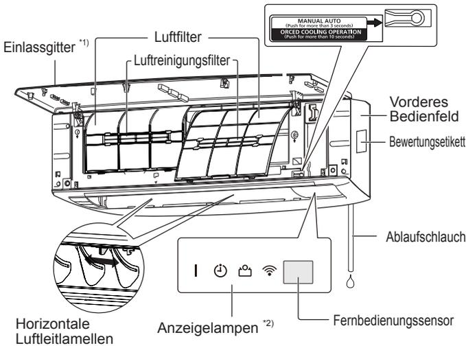
\*1) Bevor Sie den Betrieb starten, stellen Sie sicher, dass das Einlassgitter vollständig geschlossen wurde. Ein unvollständiges Schließen kann ein Einfluss auf die korrekte Funktion oder die Leistung des Produkts haben.
