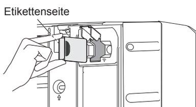
5. Schließen Sie den WLAN-Adapterdeckel und das Einlassgitter.
