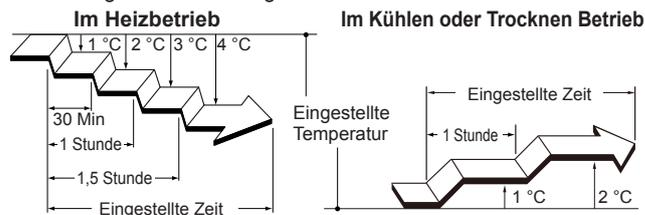
Nach Ablauf der eingestellten Zeit wird die Klimaanlage ausgeschaltet.
