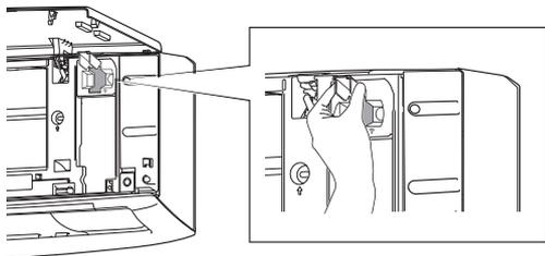
4. Stecken Sie den WLAN-Adapter in den Verbindungsanschluss des Innengerätes in Richtung wie in der Abbildung dargestellt.
