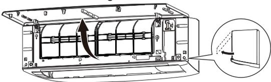
3. Öffnen Sie die Abdeckung des WLAN-Adapters, bis sie einrastet.
