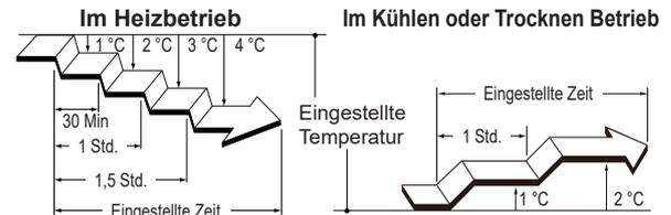
Nach Ablauf der eingestellten Zeit wird die Klimaanlage ausgeschaltet.
