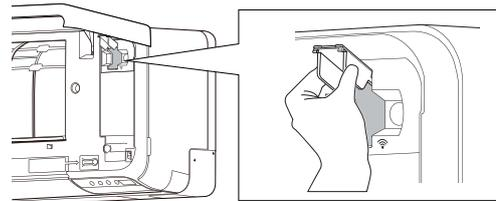
4. Entfernen Sie den WLAN-Adapter vom Verbindungsanschluss des Innengerätes in Richtung wie in der Abbildung dargestellt.
