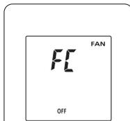
**HINWEIS:** Wenn Sie 30 Sekunden lang keine Tasten drücken, nachdem **FE** angezeigt wird, **FE** wird das Gerät ausgeschaltet. In diesem Fall wiederholen Sie Schritt 2.
