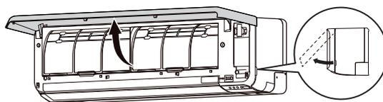
3. Öffnen Sie die Abdeckung des WLAN-Adapters, bis sie einrastet.
