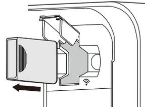
5. Schließen Sie den WLAN-Adapterdeckel und das Einlassgitter.
