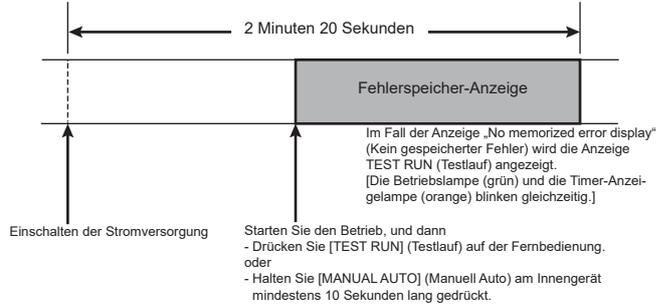
\*: Der Zeitraum „3 Minuten ST“ dauert 2 Minuten und 20 Sekunden nach dem Einschalten der Stromversorgung.
