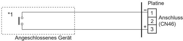
\*1: Der Schalter kann unter folgender Bedingung verwendet werden: DC 12 V bis 24 V, 1 mA bis 15 mA.
