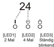
Die erste und zweite Ziffer des Fehlercodes werden durch die Häufigkeit des Blinkens der Lampe angezeigt.
