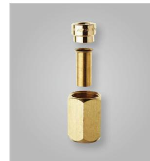
Anschluss von Kältemittel-Leitungen: Nutzung von SAE Verschraubungen, um Undichtigkeiten durch nicht perfekt ausgeführte Bördel zu vermeiden
