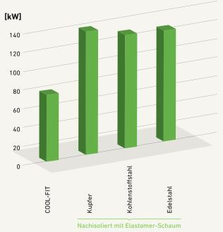
COOL-FIT ist, bei ansonsten gleicher Installation, durchschnittlich 30 Prozent energieeffizienter als Rohrleitungssysteme aus Metall, die nachträglich mit einem Schaum auf Kautschukbasis isoliert wurden.
