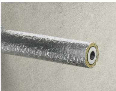
Innerhalb von Fluchtwegen dürfen nur nichtbrennbare Systeme installiert werden. Die Fa. Rockwool bietet mit Rockwool 800 eine Umhüllung aus Steinwolle, die auf Kunststoffrohren als brandschutztechnische Kapselung für Flucht- und Rettungswege eingesetzt werden kann. Diese Lösung darf auf Rohren mit maximal 160 mm Aussendurchmesser angewendet werden.
