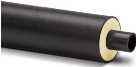
Die COOL-FIT 2.0 Innenrohre sind aus PE100 gefertigt. Die Isolation aus hocheffizientem GF-HE Hartschaum hat eine Wärmeleitfähigkeit  $\lambda$  von 0.022 W/mK. Die Rohre sind geschützt durch einen schlagfesten PE-Mantel.
