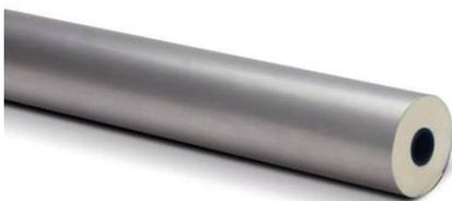
Die COOL-FIT 2.0M Innenrohre sind aus PE100 gefertigt. Die Isolation aus PIR-Schaum hat eine Wärmeleitfähigkeit  $\lambda$  von 0.022 W/mK. Die Rohre sind geschützt durch einen brandlastreduzierenden Edelstahlmantel.
