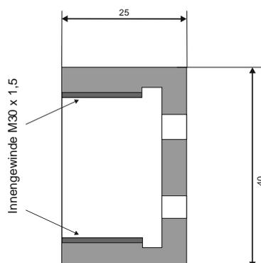
Abb. 1: Abmessungen Kappe
