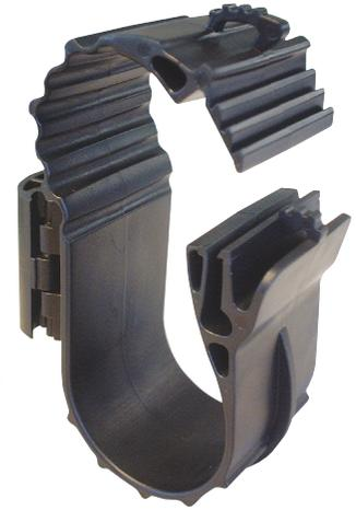
Diese Aufhänger lassen sich an Gewindestangen M6–M10 durch einen Ratschenverschluss leicht befestigen. Die isolierten Doppelrohre werden einfach übereinander angeordnet und mit Hilfe des zweiten Ratschenverschlusses fixiert.
