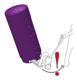
Bild 8: Achtung Kippgefahr bei unsachgemäßer Beförderung.
