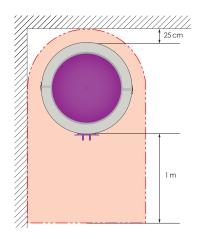
Bild 9: Freiraum um und vor dem gedämmten Kombispeicher.
