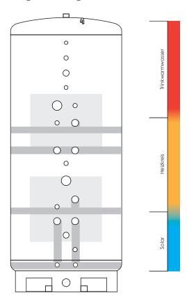
Bild 4: Darstellung der thermischen Schichtung.
