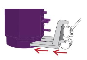
Bild 7: Einschubrichtung für Flurfördergeräte von vorne bei den Öffnungen im Fußring.
