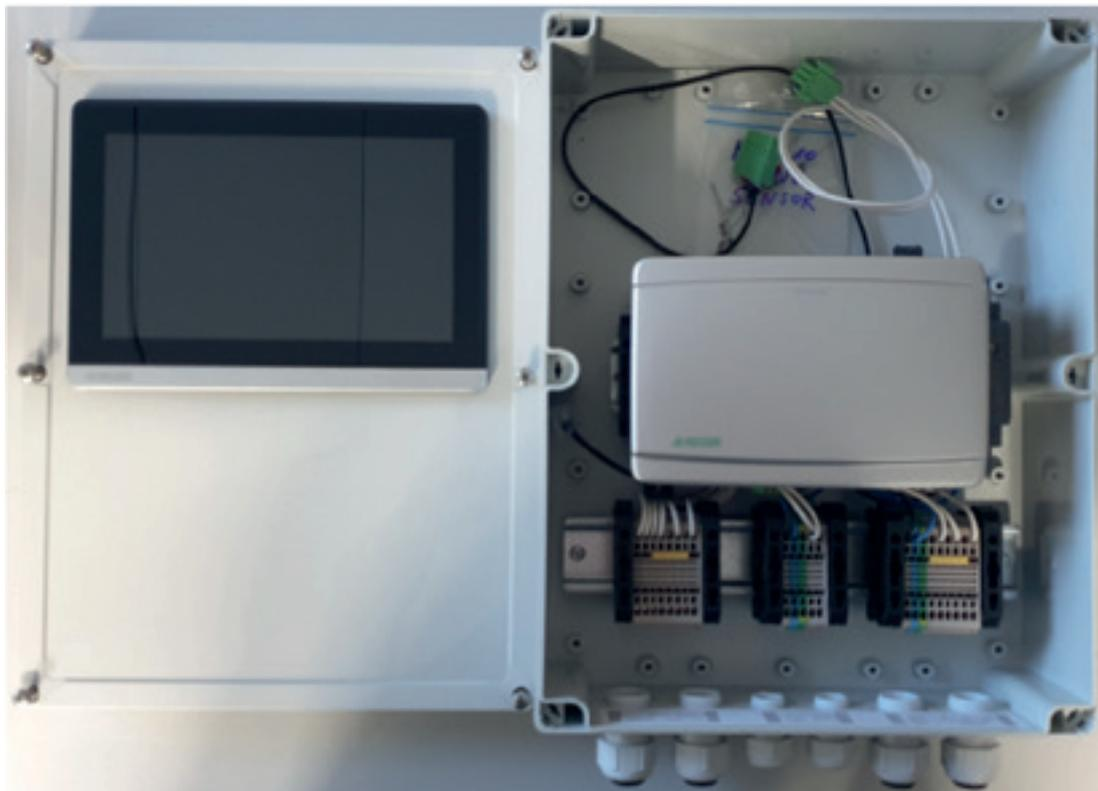
Im Auslieferungszustand sind die beiden Stecker für die Spannungsversorgung und die Kommunikation nicht am Display angeschlossen. Somit kann der Gehäusedeckel komplett abgenommen werden, was die Wandmontage und das Anklemmen aller Leitungen zur Anlage erleichtert.
