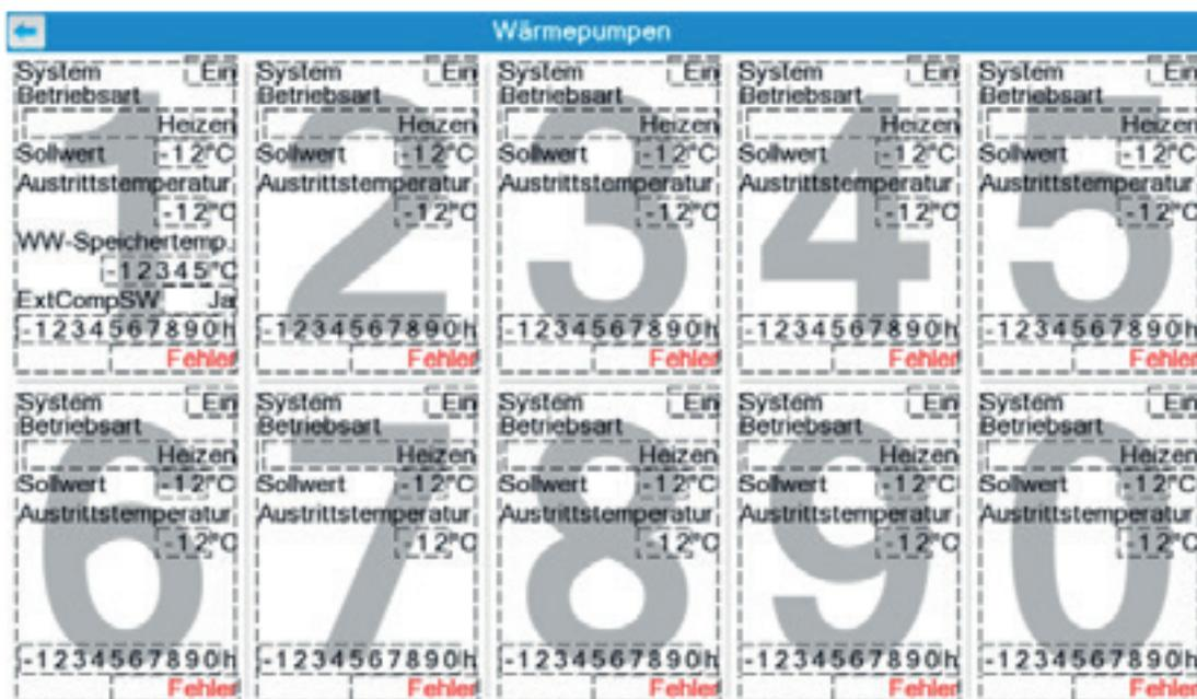
Die Wärmepumpen 2 – 10 werden vom Kaskadenmanager ein- bzw. ausgeschaltet (**System = Ein/Aus**). Außerdem wird ihre Betriebsart (**Heizen / Kühlen / WW**) gewechselt und der **Sollwert** (abhängig vom aktuellen Bedarf) direkt vorgegeben.
