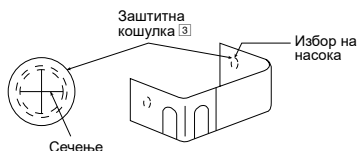
ДЕТАЛИ ЗА СПРОВЕДУВАЊЕ КАБЕЛ ЗА ПОВРЗУВАЊЕ
