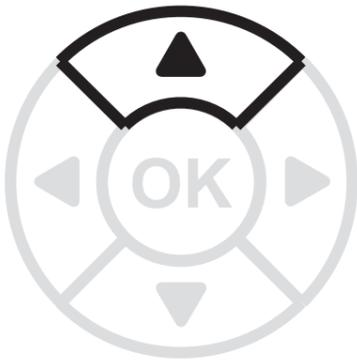
Um in das TEST Menü der Installation zu gelangen, drücken Sie mindestens 5sec lang gleichzeitig auf die MENÜ Taste und den Pfeil NACH OBEN.
