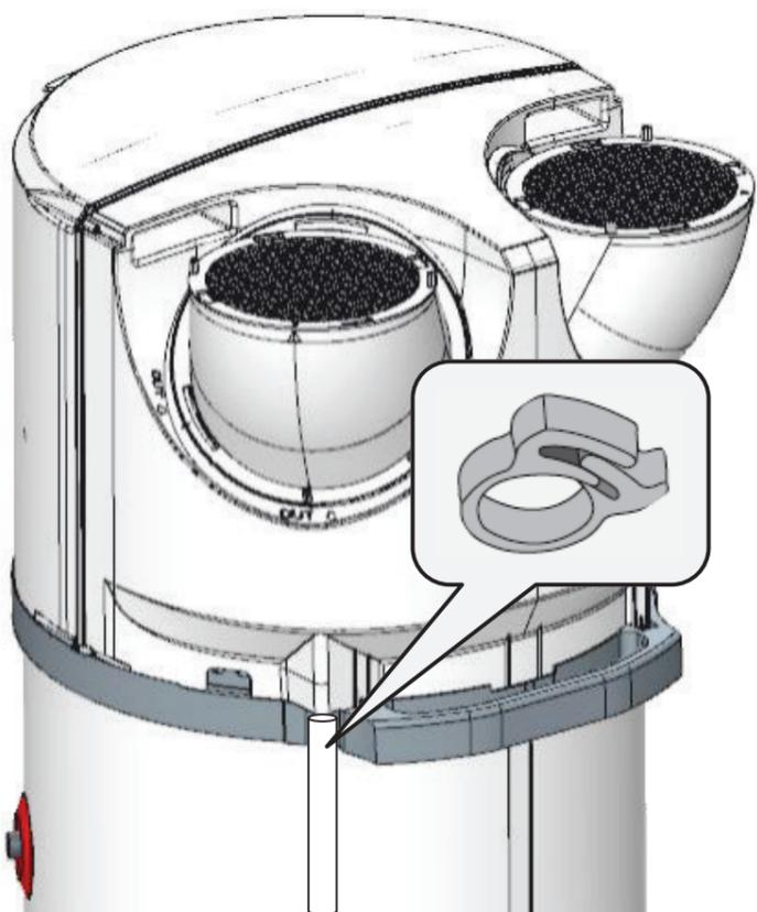
1. Stülpen Sie den Kondensat Ablaufschlauch über den Kondensatablaufanschluss rechts hinten am Gerät.
