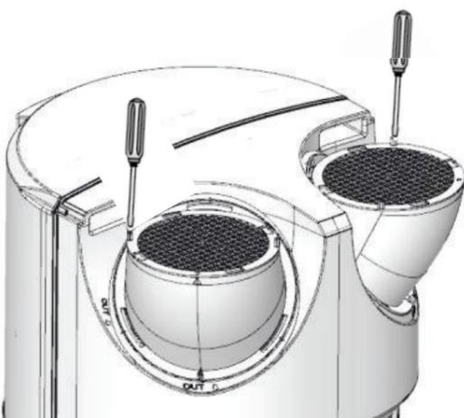
**1** Entfernen Sie die Festellschrauben der Abdeckgitter für Umluftbetrieb.
