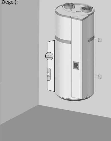
Schneide die Schablone auf den Karton aus und benutze sie, um die Markierungen zu machen. Weiter zum Schrauben der Schrauben  $\varnothing$  10mm oder zum Durchstechen von Dübeln vom Typ MOLLY  $\varnothing$  10mm. Die Mauer muss mindestens 300 kg belasten.
