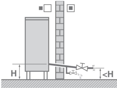
Wenn Wasser im System steht, besteht die Gefahr des Einfrierens, wodurch das System beschädigt werden kann.
