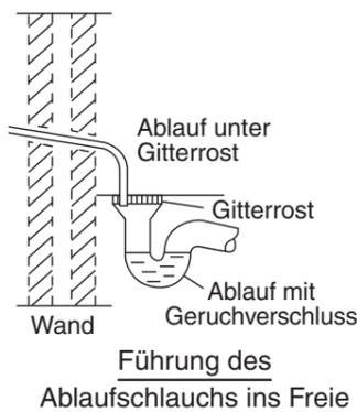
**(D) Entleerung des Warmwasserspeichergeräts (Abflusshahn) und Rohrleitungen des Sicherheitsventils**
