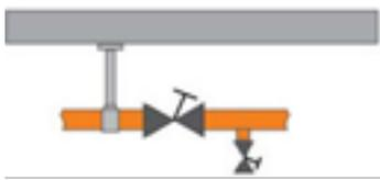
ÜBLICHE MONTAGE: Kugelhahn und Füll/Entleerventil
