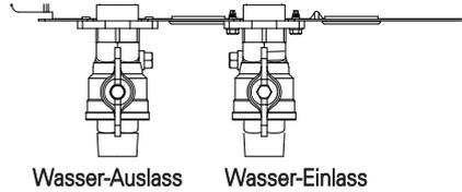
**Schritt 3.** Beginnen Sie die Wasserbefüllung. Während der Wasserbefüllung sollten die folgenden Punkte beachtet werden.
