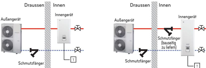
\* Die Installationsszene für den Wassereinlass / Wasserauslass kann je nach Modell variieren.
