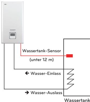
\* Die Installationsszene für den Wassereinlass / Wasserauslass kann je nach Modell variieren.
