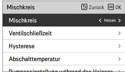
Sie können die Ventilschließzeit [s] und die Hysteresetemperatur [°C] auf dem Bildschirm selbst einstellen. Die Einstellung der Abschalttemperatur schützt davor, dass das Wasser während des Heizbetriebs oberhalb der Abschalttemperatur in den Mischkreis fließt.
