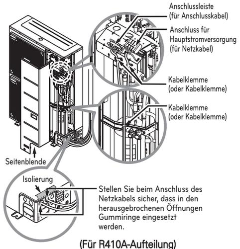
**Schritt 3.** : Verwenden Sie Kabelklemmen, um ein Verrutschen des Netz- und Anschlusskabels zu verhindern.
