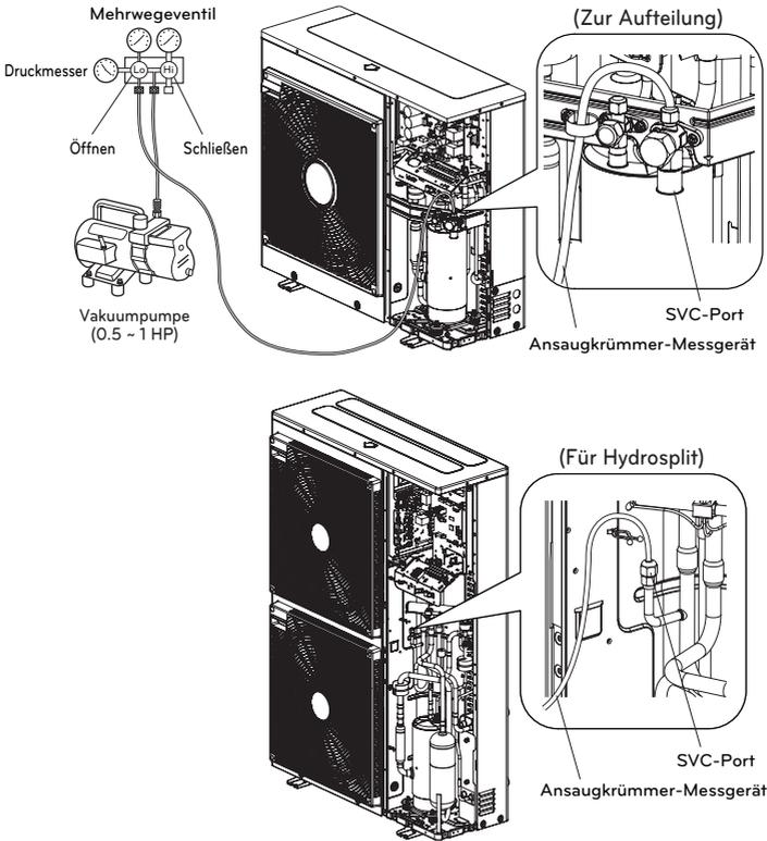
Wenn Sie ein Vakuum auswählen, sollten Sie ein auswählen, das imstande ist, ein Vakuum von 0.2 Torr zu erreichen. Der Vakuumsgrad wird in Torr, mmHg und Pascal (Pa) angegeben. Die Einheiten korrelieren miteinander wie folgt :
