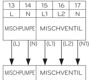
(L) : Live-Signal von PCB zu der Mischpumpe.
