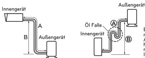
Ein Siphon ist notwendig, wenn die Außeneinheit in einer höheren Position montiert ist als die Inneneinheit.
