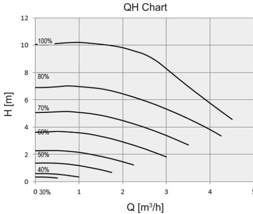
Leistungstest basiert auf Standard ISO 9906 mit Vordruck 2.0 bar und Flüssigkeitstemperatur 20 °C.
