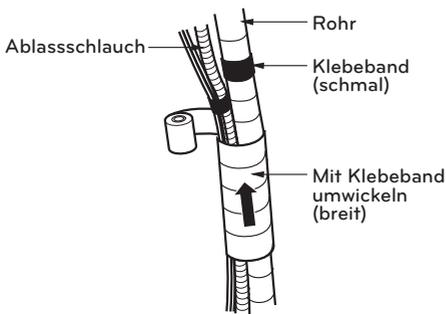
Biegen Sie die Rohre, indem Sie den Anschlusskabel und Kältemittelrohr (zwischen Innengerät und Außengerät) mit Isolation umwickeln und diese mit zwei Klebebändern fixieren.
