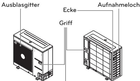
Halten Sie das Gerät immer an den Ecken, da ein Halten an den Seiten die Aufnahmeloeh am Gehäuse deformieren könnte.
