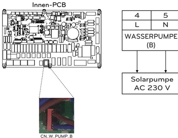
(Für das Split-R32-Innengerät der 4er Reihe, für das Split-R410A-Innengerät der 3er Reihe)
