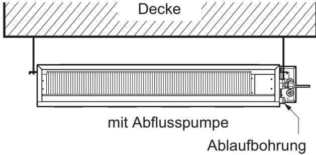
**Deckeneinbaukanal - schwach statisch**
