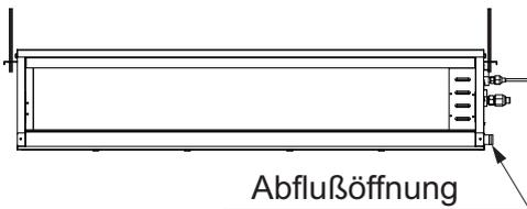
**Deckeneinbaukanal - mittel statisch**
