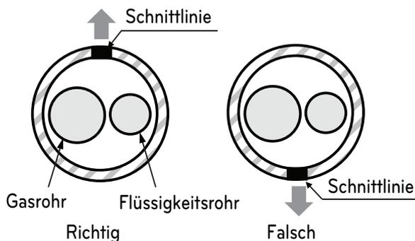
\* Schnittlinie der Rohrleitung muss nach oben zeigen.
