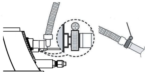
2. Positionieren Sie die Schraube der Klemmverbindung aufwärts, um den Anschluss zu sichern.
