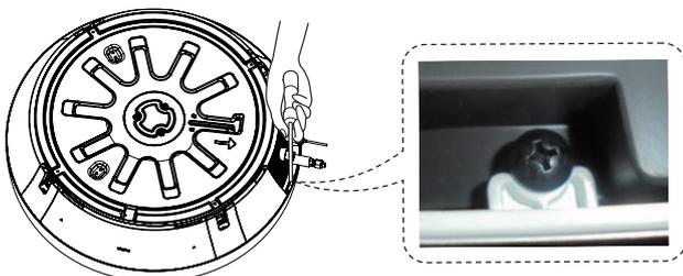
Die Schrauben zur Befestigung der Dekorblende sind im Zubehör des Innengerätes enthalten.
