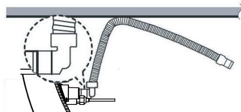
1. Verbinden Sie den Winkelanschluss mit dem Gerät, das aufwärts gerichtet ist.
