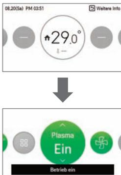
Im Einzelbetrieb der Plasma-Luftreinigung wird das Gerät in den Lüfterbetrieb/automatischem Luftzugbetrieb umgeschaltet, so dass die Luftstromrichtung geregelt wird, bevor die Plasma-Luftreinigung im Einzelbetrieb ausgeschaltet wird.
