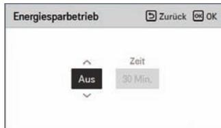
Die möglichen Einstellungen lauten AUS ↔ Ein/Aus-Energiesparbetrieb ↔ Temperatur-Energiesparbetrieb.
