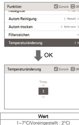
Die Funktion kann nur bei Kühl-/Heizprodukten verwendet werden.
