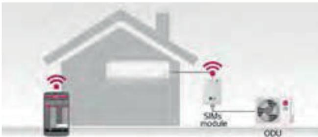
Überwacht den Status der Klimaanlage und diagnostiziert Probleme, indem eine Verbindung zum Smartphone via SIM-Modul hergestellt wird.
