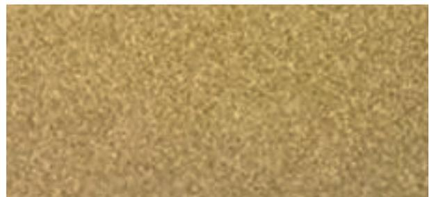
\* Testergebnis 360 Stunden nach Aussetzung durch Natriumchlorid
