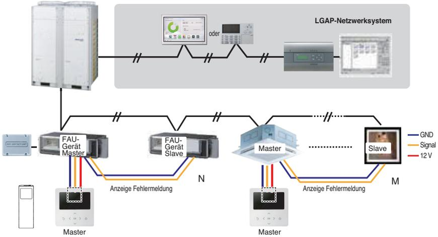
※ Bei gemeinsamer Montage eines Standard-Innengerätes und eines Gerätes mit Frischluftzufuhr müssen das Gerät mit Frischluftzufuhr und die Standardgeräte separat angeschlossen werden. ( $N, M \leq 16$ ) (Die eingestellten Temperaturen sind unterschiedlich.)
