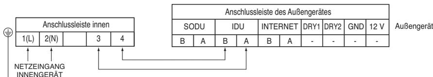
※ Bei Überprüfung auf fehlerhafte Verkabelung zu messende Anschlüsse. (TY / 4 / 2 / 1-Wege)
