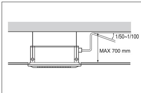
3. Für die Kondensatleitung ist eine Wärmedämmung mit einer Stärke von 5 mm oder mehr erforderlich.
