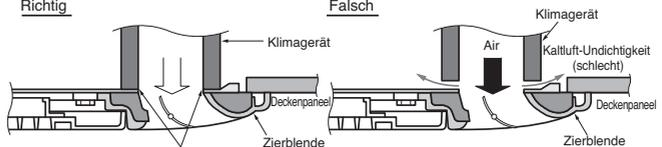
Montieren Sie die Isolierung (dieses Teil), und achten Sie darauf, dass es keine Kaltluft-Undichtigkeiten gibt.
