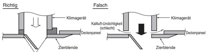
Montieren Sie die Isolierung (dieses Teil), und achten Sie darauf, dass es keine Kaltluft-Undichtigkeiten gibt.
