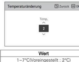
Die Funktion kann nur bei Kühl-/Heizprodukten verwendet werden.
