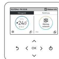
Wenn Sie die Klimaanlage und den Lüfter mit einer Fernbedienung kontrollieren, wird dies auf dem Bildschirm wie im nebenstehenden Schaubild angezeigt. Sie können die Klimaanlage auf dem Bildschirm der Klimaanlage einstellen, indem Sie die [<(links)] Taste drücken und anschließend die [OK] Taste drücken.
