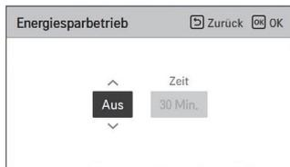
Die möglichen Einstellungen lauten AUS ↔ Ein/Aus-Energiesparbetrieb ↔ Temperatursteuerung ↔ Energiesparbetrieb basierend auf Aktivität.
