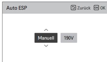
Nach Auswahl der Spannungseinstellung arbeitet das Gerät automatisch und die Rotationsgeschwindigkeit wird automatisch für jede Lüfterdrehzahl eingestellt - Hoch, Mittel oder Niedrig. Prüfen Sie den Gerätetyp und wählen Sie „Auto“ bei einem Einzelgerät bzw. „Manuell“ bei einem Multi V-Gerät aus.
