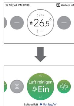
Im Einzelbetrieb der Luft reinigen wird das Gerät in den Lüfterbetrieb/automatischem Luftzugbetrieb umgeschaltet, so dass die Luftstromrichtung geregelt wird, bevor die Luft reinigen im Einzelbetrieb ausgeschaltet wird.
