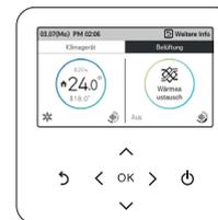
Wenn Sie die Klimaanlage und den Lüfter mit einer Fernbedienung kontrollieren, wird dies auf dem Bildschirm wie im nebenstehenden Schaubild angezeigt. Sie können den Lüfter auf dem Bildschirm des Lüfters einstellen, indem Sie die [>(rechts)] Taste drücken und anschließend die [OK] Taste drücken.
