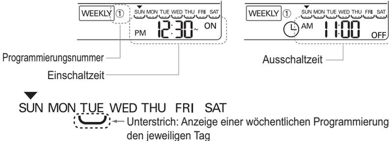
\* Das Innengerät wird eingeschaltet und die gewünschte Temperatur eingestellt, falls diese während der Programmierung der wöchentlichen Betriebszeiten mit den Tasten Auf/Ab eingestellt wurde.
