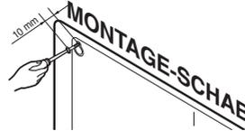
7. Gerät mit den Löchern in die oberen Schrauben einhängen und Schablone entfernen. (Auf mögliches Herunterfallen achten)
