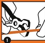
Den Schlauch QUADRA DN2 mit der Spezialschere Bestell-Nr. WXAO04 auf die gewünschte Länge zuschneiden.
