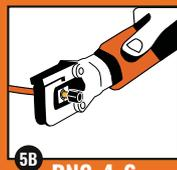
Die Fassung mit der Presse RXA010 verpressen. Die Pressmaschine stoppt automatisch sobald die optimale Verformung erreicht ist.
