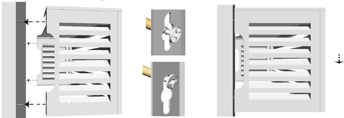
Wenn Sie die Abdeckung abnehmen möchten, erhöhen Sie die Höhe bitte leicht entsprechend der Position der Schraubenlöcher und ziehen Sie es einfach durch die Mitte der letzten Lochposition der Zeichnung nach außen. Dies ist eine einfache Installation, die auch ein schnelles Entfernen unserer Abdeckung für die Systemwartung ermöglicht.
