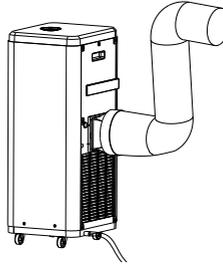
Schließen Sie das flache Anschlussstück (Schlauchanschluss-Fensterende) an den Schlauch an, und ziehen Sie den Schlauch so weit heraus, wie er für den Außenbereich erforderlich ist. Verbinden Sie das andere Ende mit der Klimaanlage.
