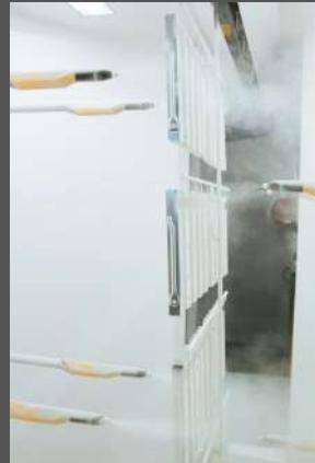
**Resistente al tempo**, prodotta in acciaio pre-zincato e protetta con verniciatura a polveri poliesteri RAL 9002 di spessore medio 100 µm, resistenza a test in nebbia salina fino ad una durata di applicazione di 500 ore
