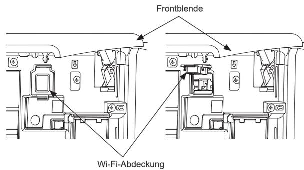
Dieses Wi-Fi-Modul wird an ein Innengerät angeschlossen und dient zur Übermittlung von Statusinformationen und Steuerung der Befehle von MELCloud.
