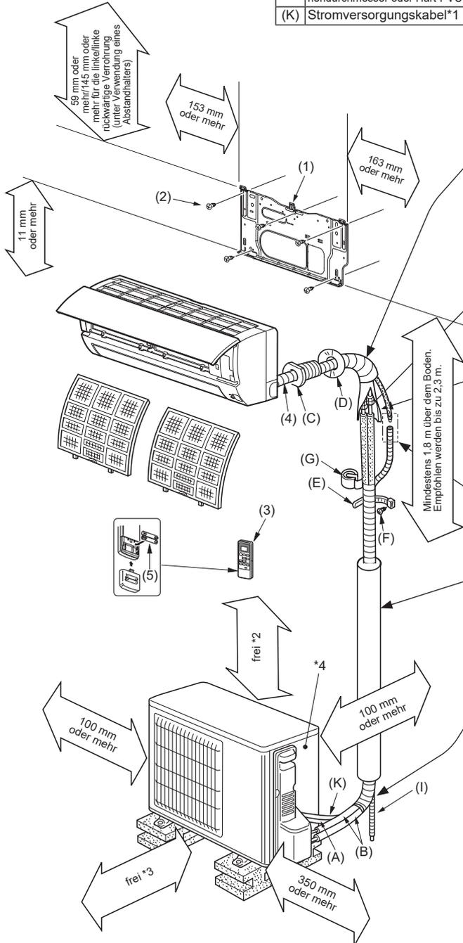
Verwenden Sie unbedingt die Wanddurchbruchhülse (C), um einen Kontakt des Innen-/Außengerät-Verbindungskabels (A) mit Metallteilen in der Wand sowie Beschädigungen durch Ratten bei Hohlwänden zu verhindern.
