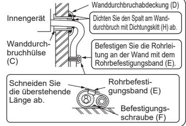
Tragen Sie nach dem Lecktest das Isolationsmaterial dicht auf, sodass kein Spalt übrig bleibt.
