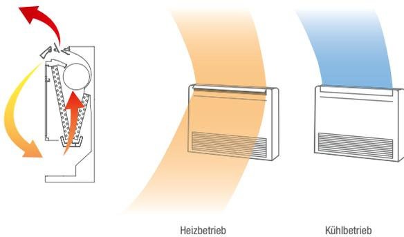
Das Truhengerät MFZ-KW ist besonders für Anwendungen geeignet, in denen sowohl der Kühl- als auch der Heizbetrieb regelmäßig zum Einsatz kommt. Wie ein Heizkörper in Bodennähe aufstellbar.
