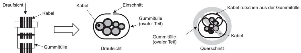
\*2 Achten Sie bei der Kabelverlegung durch die Gummitülle darauf, dass die Tülle sich nicht vom Blech am Steuerkasten löst.
