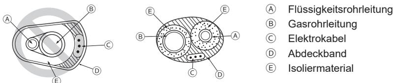
• Achten Sie darauf, dass die Rohrverbindungen vom Innengerät komplett sachgemäß isoliert sind.
