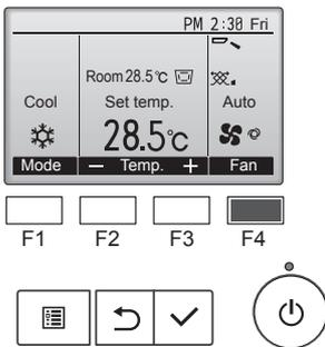
Drücken Sie [F4], um die Lüftergeschwindigkeit in folgender Reihenfolge zu durchlaufen.
