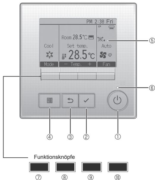
Die Funktionen der Funktionsknöpfe ändern sich je nach Anzeige. Details finden Sie in der Funktionshilfe für Knöpfe, welche für die Funktion der aktuellen Anzeige am unteren Teil des LCD erscheint. Wenn das System zentralgesteuert wird, wird die Funktionshilfe der entsprechenden gesperrten Knöpfe nicht angezeigt.
