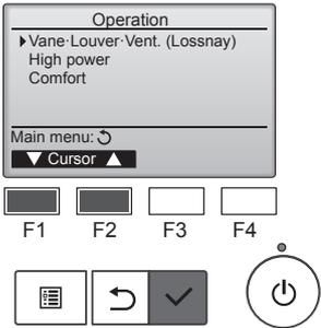
Wählen Sie „Vane-Louver-Lüftung (Lossnay)“ (Flügel/Klappe/Auslass (Lossnay)) aus dem Betriebsmenü und drücken Sie [AUSWAHL].
