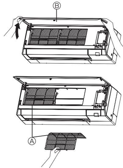
① Ziehen Sie an die beiden unteren Ecken des Gitters, um es zu öffnen, und heben Sie dann den Filter an.
