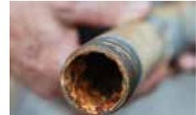
Schmutzpartikel können während der Installation, der Benutzung oder bei Wartungsarbeiten in die Anlage gelangen. Auch ein falscher pH-Wert und eine hohe Leitfähigkeit führen zu unerwünschten Schmutzpartikeln. Das Systemwasser hat idealerweise einen pH-Wert zwischen 7 und 10. Zur Beschränkung anfangs in die Anlage gelangender Schmutzpartikel ist es wichtig, dass die Anlage vor dem Befüllen gut durchgespült wird.
