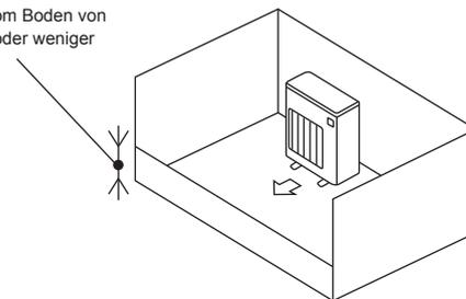
C) Für eine ausreichend große Belüftungsöffnung sorgen.
