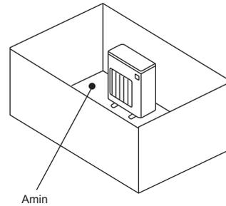
B) In einem Raum mit einer Absenkung von  $\leq 0,125$  [m] installieren.
