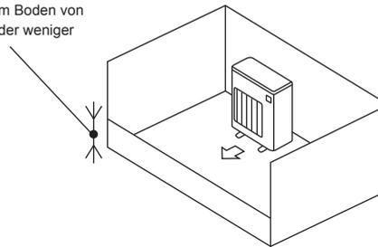
C) Für eine ausreichend große Belüftungsöffnung sorgen.
