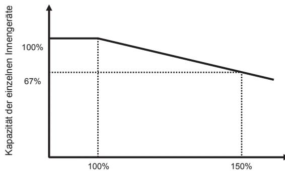
Betriebsverhalten, wenn die Gesamtkapazität der verwendeten Innengeräte über der Kapazität des Außengeräts liegt.
