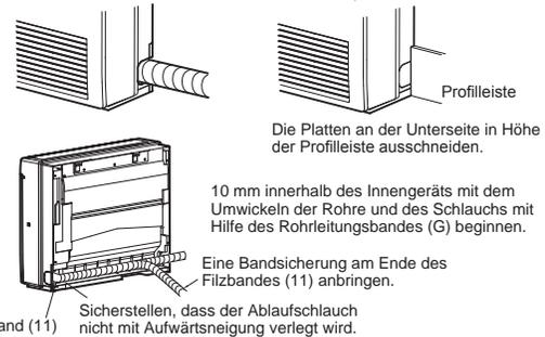
Das Filzband (11) fest um die Rohre und den Schlauch wickeln; dabei an der Stelle beginnen, wo Rohre und Schlauch vom Innengerät her verlegt werden. (Die Überlappungsbreite des Filzbandes (11) sollte nicht mehr als die 1/2 der Bandbreite betragen.)
