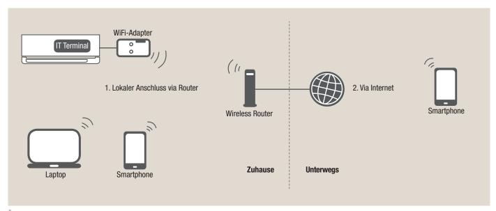
Über mobile Endgeräte Split-Klimaanlagen einfach und bequem bedienen.
