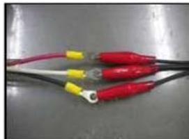
Abb. 2-6 Anschluss an Ringkabelschuh
