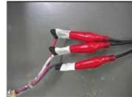
Abb. 2-4 Mit Isolierband umwickelte Klemmen
