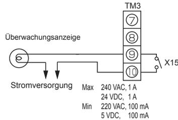
Um den Überwachungsausgang für einen Nachheizter zu verwenden, schalten Sie SW2-8 auf ON (EIN), und verwenden Sie den Luftzufuhrgebläse-Überwachungsausgang mit einem verzögerten Betrieb. (Details finden Sie unter der Funktionseinstellung **Nr. 57**.)
