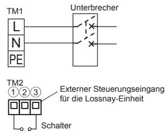
Starten/Stoppen Sie das Gerät durch einen Schalter, der an TM2 **①** **③** angeschlossen ist.
